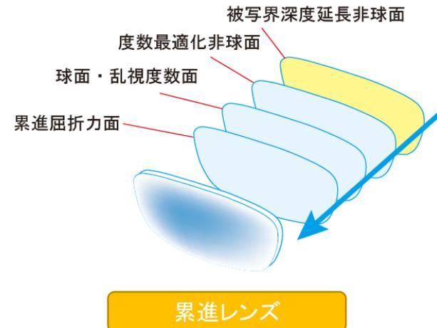
3次の非球面による被写界深度延長成分と収差・度数を最適化した偶数次の非球面を組み合わせ付加し眼鏡レンズとして安定した被写界深度延長効果を保持
